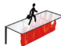
Járható tűzálló üvegfödém
