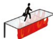
Járható tűzálló üvegfödém
